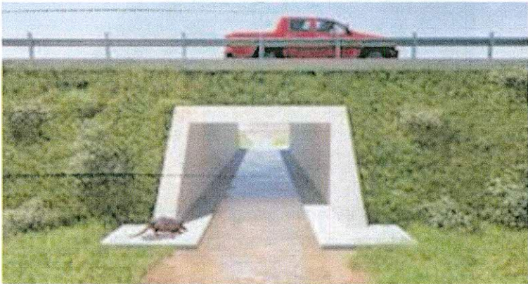
Imagen 15. Diseños pasos de fauna tipo BoxCulvert
